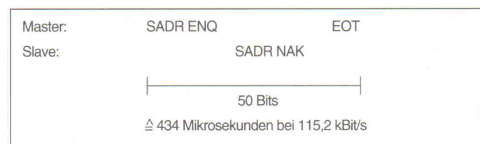
Bild 3. Frage und Antwort: Der vom Master per SADR adressierte Knoten hat keine Daten zur Übertragung anstehen und quittiert mit NAK.
