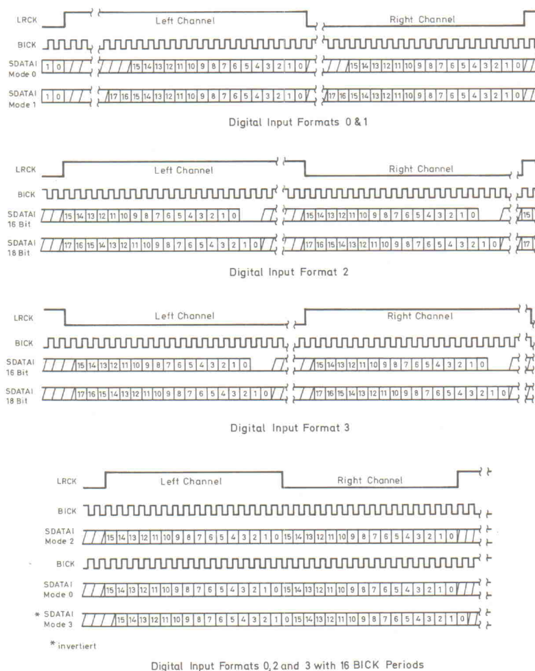
Bild 2. Die vier Eingangsformate des CS4328.
