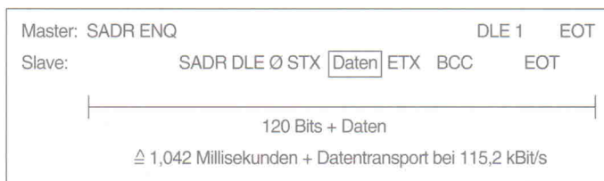
Bild 4. Datagramm: Liegen Daten für den Master bereit, schickt der Slave diese erst nach Aufforderung.
