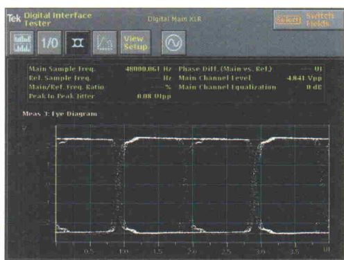
Bild 3. Eye Pattern und gleichzeitige Anzeige von Jitter, Pegel und Frequenz erlauben eine schnelle und genaue Analyse digitaler Schnittstellen.
